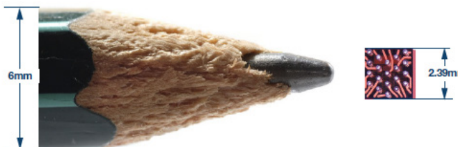
图8. AD7682/AD7689晶圆级芯片规模封装与标准铅笔的尺寸对比
