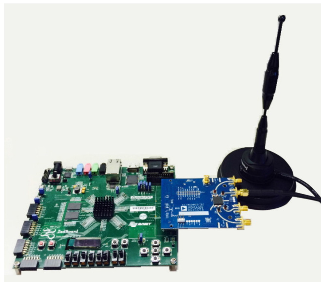
图2. ADS-B算法验证的硬件设置
