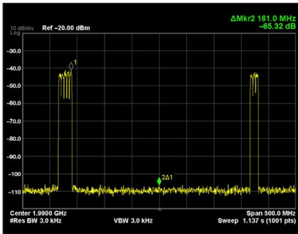
图4. 双频段WCDMA信号（1.8 GHz和2.1 GHz频段）。
