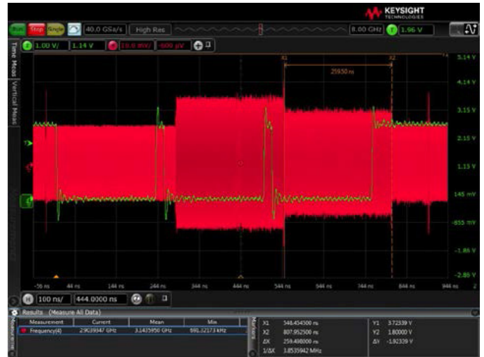
图6. AD9164的快速跳频性能—每跳260 ns驻留时间。
